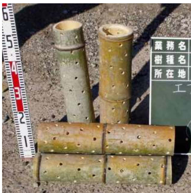
有孔管(モウソウチクを用いた空気管)
